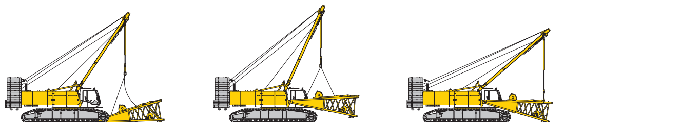
Entladung und Anbau des Auslegeranlenkstücks
