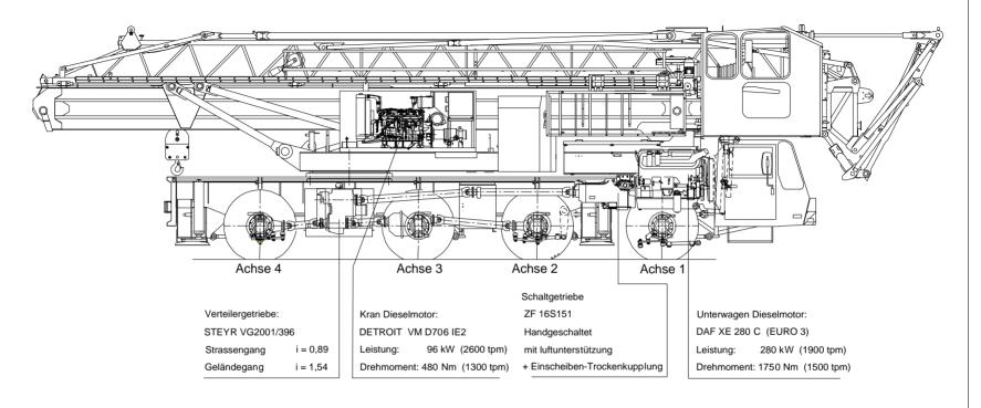
Achse 1 : Lenkachse Reifen : 445/75 R22,5
